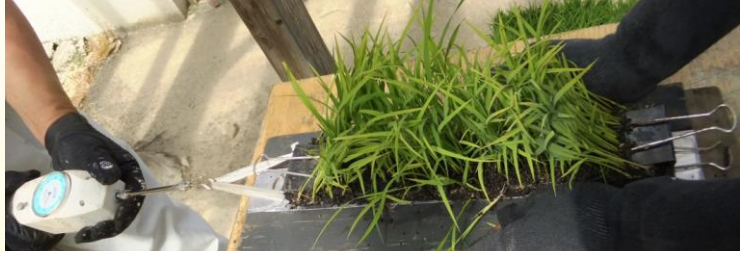
マット強度調査：5cm幅の引張破断値から算出。
